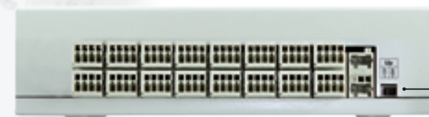
Přepínač napětí 12Vdc/24Vdc pro napájení připojených senzorů.
